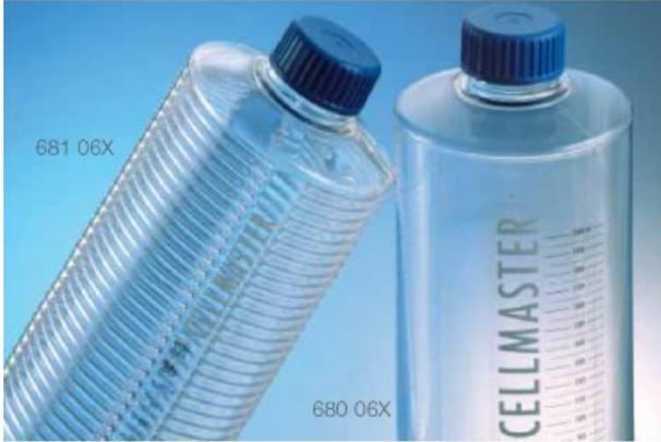
Flaconi per colture CELLMASTER ROLLER GREINER in PET 122,0X271 mm, forma scanalata area sup. 2125 cm<sup>2</sup> conf. 2 pz imballo 24 pezzi
