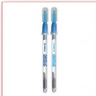
Reattivo predosato AQUASNAP per test su acque, da utilizzare con il Bioluminometro System Sure Plus, per ATP totale. I reattivi predosati evitano all'operatore di dover utilizzare pipette o flaconcini e permettono un'ottima ripetibilità delle misure. Possono essere conservati fino a 12 mesi in frigorifero o 1 mese a temperatura ambiente.
