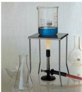
Stativo in acciaio. Dimensioni (mm): 135x135. Altezza (mm): 220.
