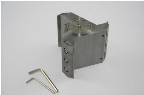
Rotore a sezione parallela in acciaio 1.0580 per SM200-SM300.
