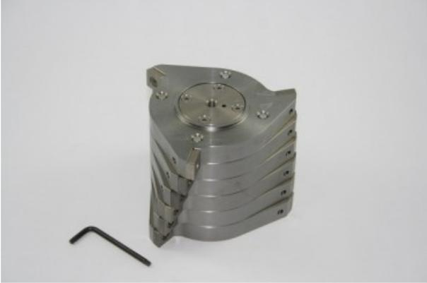
Rotore a sei dischi sfalsati in acciaio 1.0580 con placchette in carburo di tungsteno reversibili per SM200-SM300.
